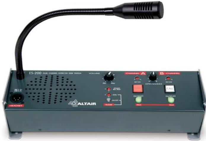
La sous station de table ES-200 qui se présente sous la forme d'un pupitre permet une communication Full Duplex, mains libres, sur les 2 canaux A et B. Cette sous station est alimentée par les câbles Intercom, elle dispose d'un micro col de cygne dynamique, directionnel, fixe et d'un haut parleur intégré.
